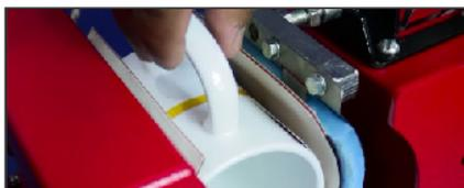
4. Encaixe a caneca na máquina. Acione a alavanca do torpedo para fechar a abraçadeira, até que, depois de exercer a pressão, permaneça travada no final do seu curso (procure fazê-lo com um só movimento).
