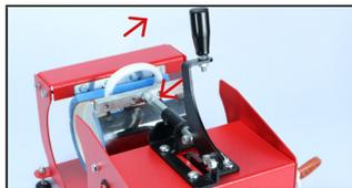
**4.** Mova a alavanca do torpede no sentido de fechar a abraçadeira, a fim de regular a pressão na peça. Para isso, gire o regulador de pressão até a pressão ideal, que é quando a borracha de resistência contorna a peça, aderindo bem a toda superfície da mesma. No sentido horário você aumenta a pressão e no sentido anti-horário diminui;
