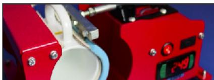
5. Ao fechar a abraçadeira, automaticamente o tempo programado de estampar é acionado. Caso não dispare o tempo automaticamente, pressione o botão de tempo no painel de controle e o temporizador começará a contagem regressiva.
