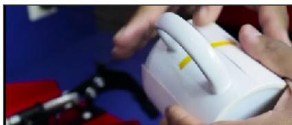
3. Fixe a estampa sobre a caneca. Para fazer isto, você poderá utilizar pedaços de fita térmica, sendo um em cada extremidade da estampa, para que não se mova quando colocada na máquina.
