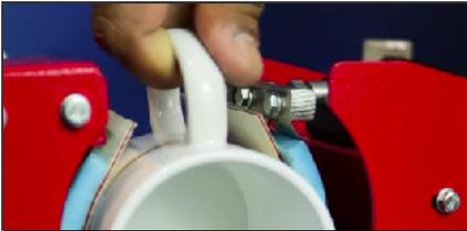
7. Retire a caneca da máquina de estampar. Manipule-a com cuidado, lembrando que ela estará com uma temperatura bastante elevada.
