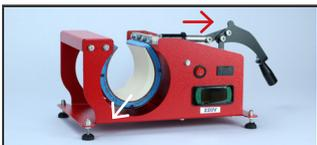
**5.** Retire a peça a ser estampada, movendo a alavanca do torpede e abrindo a abraçadeira, deixando aberta na posição de aquecimento;
